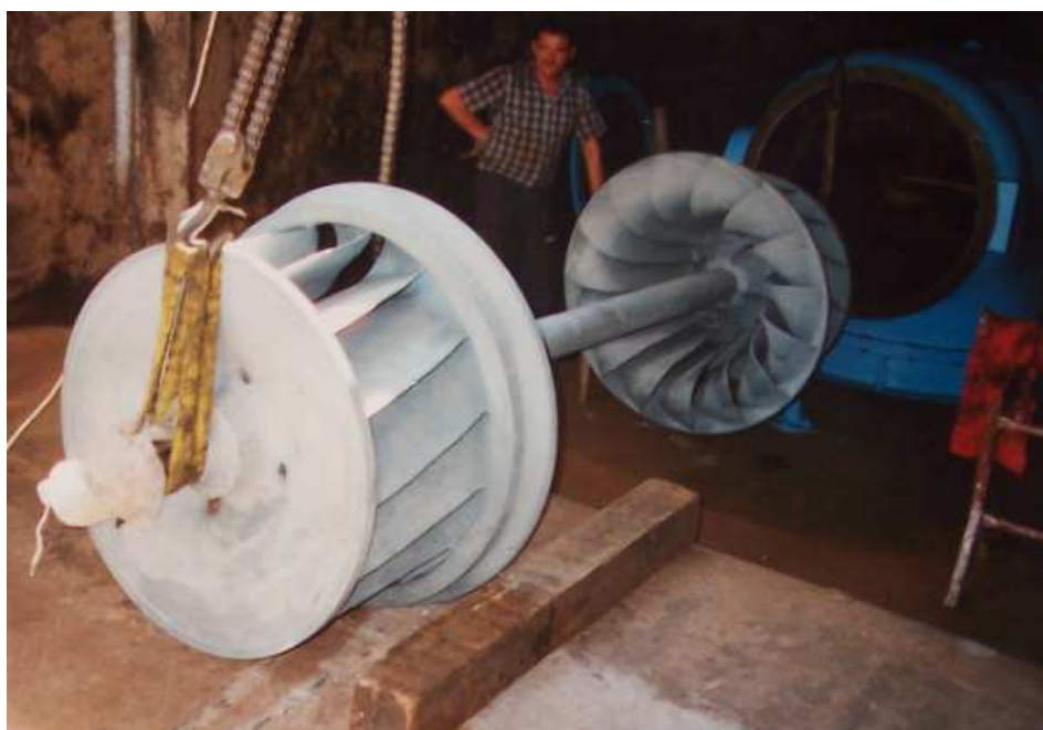
Příloha 5: Hřídel s oběžnými koly po opravě
